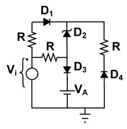
Nota: La secuencia de estados no depende de los valores de la tensión umbral, tensión zener, tensión  $V_A$  (siendo este positivo) ni del valor de la resistencia, por lo que si se prefiere se puede solucionar para unos valores concretos. Por ejemplo: tensión umbral  $V_\gamma = 0.7$  V, tensión zener  $|V_Z| = 3.3$  V,  $V_A = 6$  V y R = 1 k $\Omega$ .
